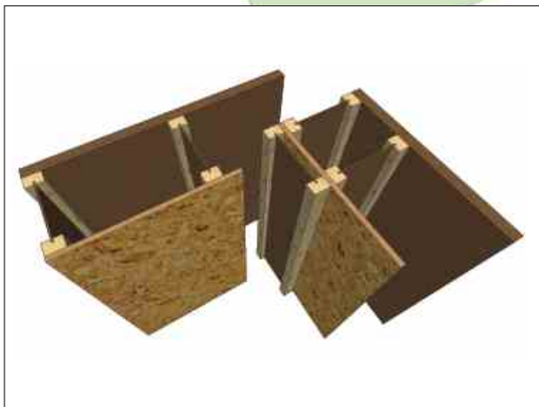
ROHOVÝ SPOJ - SKELETOVÁ KONSTRUKCE
