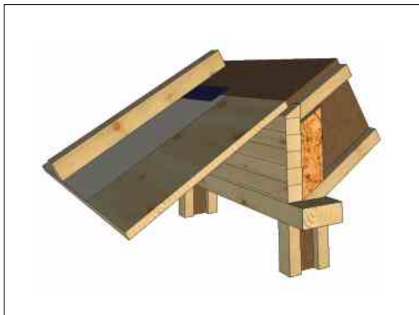
PŘESAH STŘECHY S I-NOSNÍKEM ZASAZENÝM ŠIKMO DO POZEDNICE
