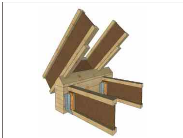
PŘESAH STŘECHY S ÚHLOVOU PODLOŽKOU
